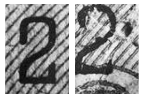
(図版) 偽造券の記番号や凹版画線が凸版印刷のため、マージナル・ゾーンが観察される
