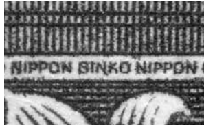
(図版) 当初の図柄部分と、ミニ改刷券で採用された連続凹版マイクロ文字「NIPPON GINKO」部分
