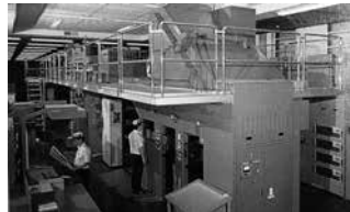
(図版) 新しい ダブル・オフセット・ザンメル凹版印刷機
