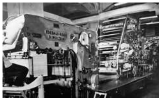
(図版) 新規に採用されたドライ・オフセット多色印刷用の「シムルタン」印刷機
