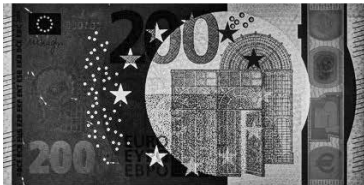
(図版) ユーロ券の長波長と短波長の紫外線発光状態、赤外線反射吸収印刷 (ECB の HP より引用)
