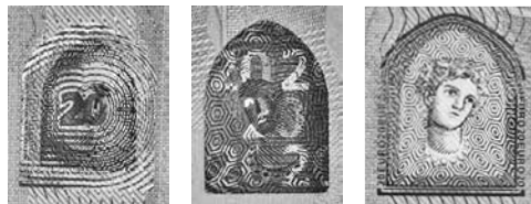
(図版) ホログラム箔ストライプの右上部の窓開き部分、表面と裏面の反射光下での状態、透過光下での状態
