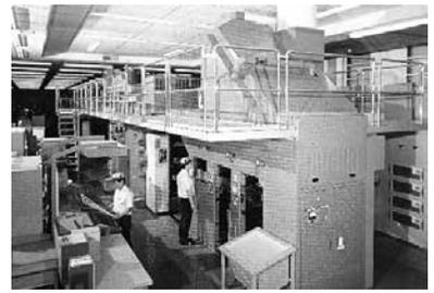
ダブルオフセット・ザンメル凹版輪転印刷機
