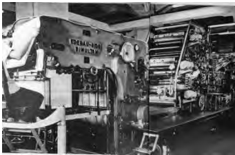
ドイツ製のシムルタン輪転印刷機（表裏5色ドライオフセット印刷）とその構造図
