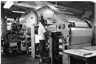
ドイツ製のジョリ4P凹版輪転印刷機（凹版ザンメル印刷）とその構造図
